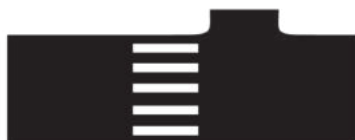
SENDAS PEATONAL (Prohibido detener o estacionar vehículos sobre la misma)
