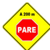
PROXIMIDAD DE SEÑAL RESTRICTIVA (Pare)
